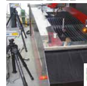
Gleichzeitige Überprüfung von Genauigkeit und Positionierung durch zweifachen Renishaw-Laser (Linearität)
