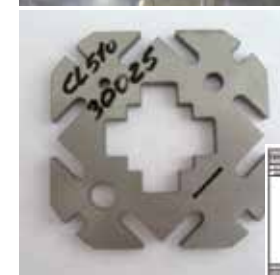
Schneidetest für die Endkontrolle
