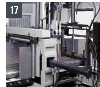
SHARK 350 CNC HS 4.0 - SHARK 350 NC HS 5.0 étaux verticaux hydrauliques pour coupe en paquets (max 350x350 mm)
