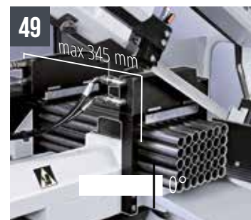
49 SHARK 281 NC 5.0 - Étaux verticaux hydrauliques pour coupe en paquets (max 170x130 mm)
