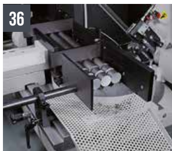
36 SHARK 332 NC 5.0 - Dispositif pour la coupe en paquet et guide réglable pour le déchargement (max 240x90)
