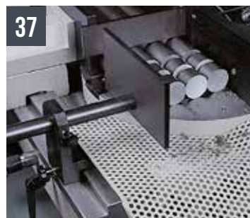
37 SHARK 282 NC 5.0 / 332 NC 5.0 Guide réglable pour la chute des pièces coupées
