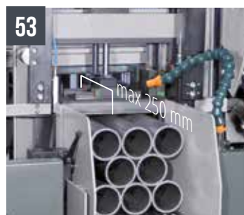
53 SHARK 230 NC HS 5.0 - Étaux verticaux hydrauliques pour coupe en paquets (max 230x230 mm)
