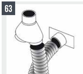
63 COBRA NC 5.0 Dispositif double aspiration
