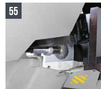
55 SHARK 332 SXI/NC 5.0 - 382 SXI Dispositif de nettoyage de la lame par brosse avec moteur
