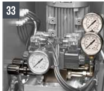
33 SHARK NC 5.0 Régulateur pression étaux hydrauliques
