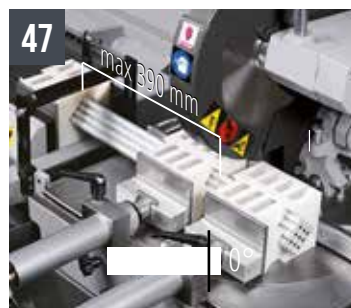
47 COBRA 352 NC 5.0 - Série de mâchoires à peigne en nylon 75x75 mm max.
