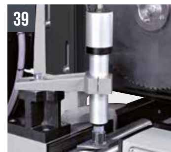
39 TIGER 352MA/COBRA 352MA Étau vertical pneumatique
